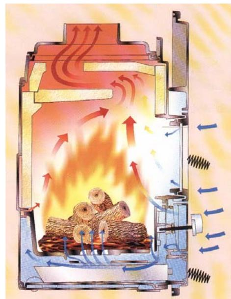
Heizeinsätze mit nachgeschalteten Wärmetauscher für Warmluftkachelöfen. Nachgeschaltete Wärmetauscher bestehen in der Regel aus Metall. Die Wärmeabgabe erfolgt überwiegend konvektiv über die Heizkammer und zum Teil über die äußeren Oberflächen. Sie sind für den temporären Einsatz gut geeignet.
