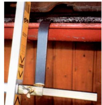
An der Leiter befestigter Sicherheitsbügel
